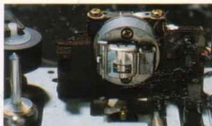
Rotating heads für beste Azimuteinstellung.
