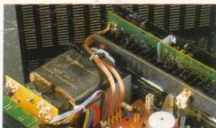
Der Ausgangsleistung entsprechende, großdimensionierte Leitungsführung.
